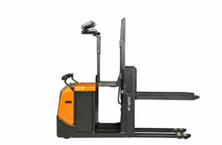
Varios modelos cuentan con plataforma elevadora para la recogida en el segundo nivel
