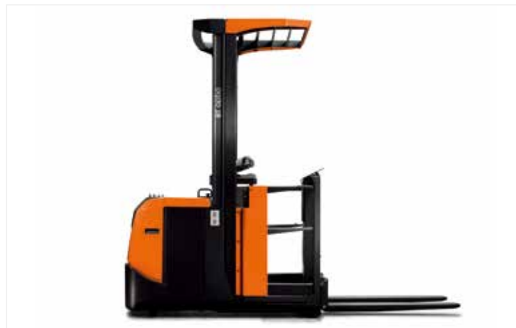
Seguridad mediante tejadillo protector
