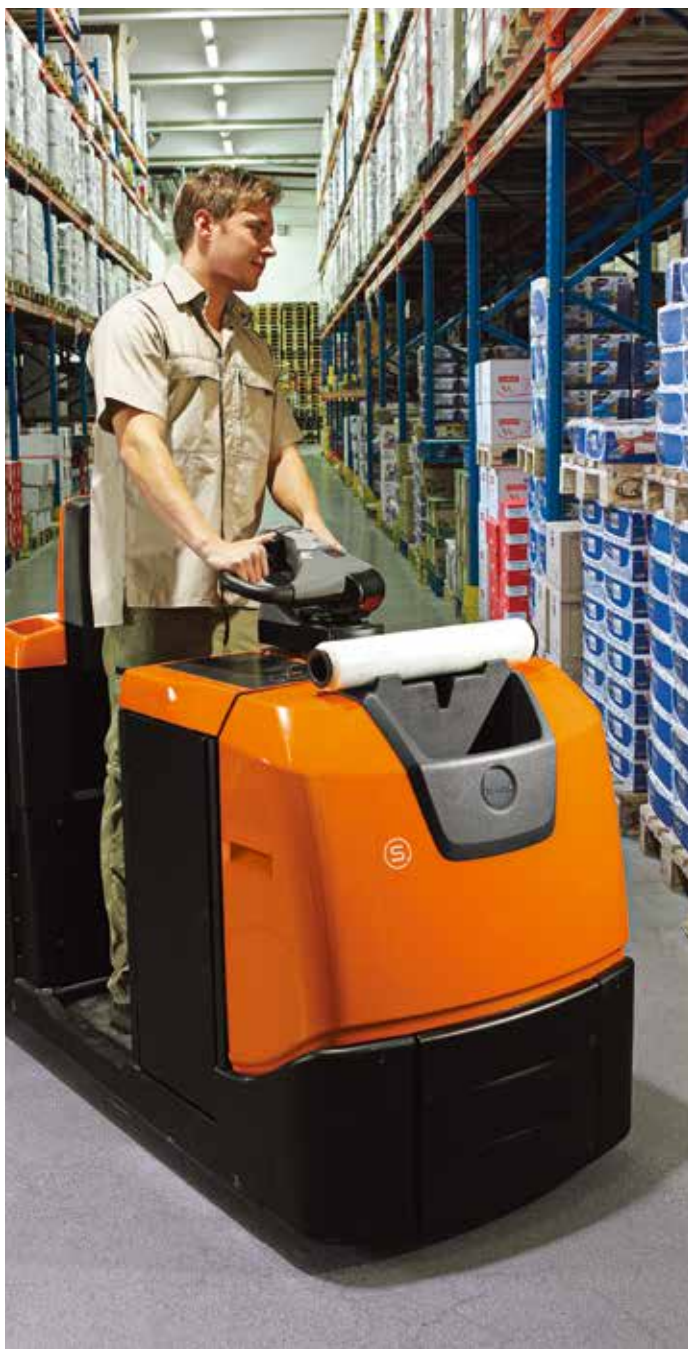
El escalón de baja altura facilita la subida y la bajada continuas
