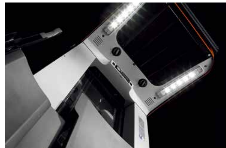
Tejadillo protector con luces LED de trabajo integradas
