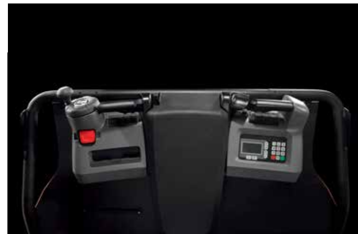
Los controles divididos ergonómicos son cómodos y permiten un acceso óptimo a las horquillas para la recogida.
