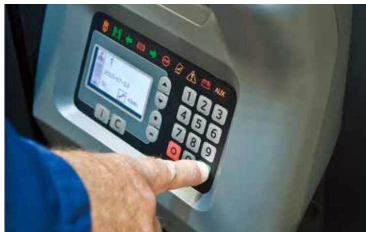
BT Access Control evita el uso no autorizado y establece los valores preestablecidos de parámetros personales de cada conductor en el arranque
