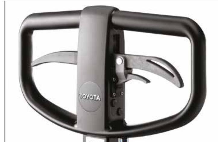
Esto se acciona mediante la palanca de control manual de la empuñadura
