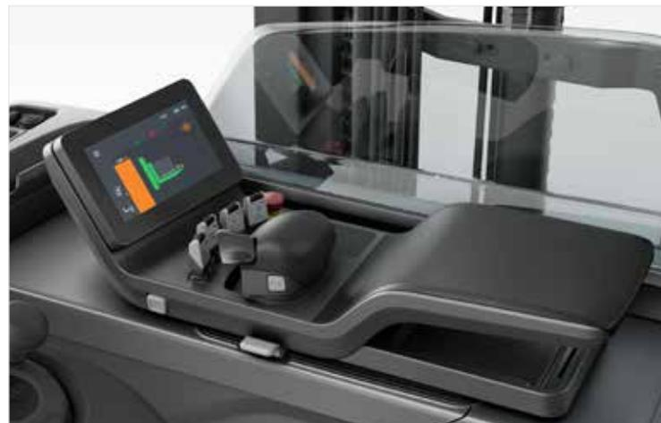
El minijoystick ajustable permite un control táctil preciso.
