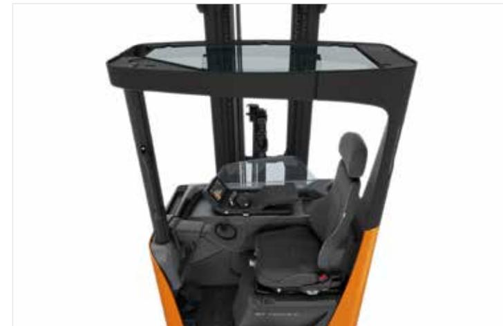
El diseño limpio del mástil y del carro portahorquillas ofrece al operario una visión excepcional de la carga en todo momento, lo que aumenta la productividad y la seguridad.
