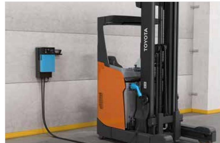
Hay disponibles tres paquetes de energía inteligentes diferentes, basados en el sistema modular de baterías de litio de Toyota, de bajo consumo energético, para adaptarse a la aplicación del cliente.
