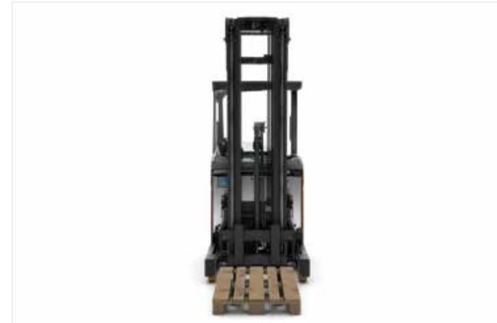
El chasis estrecho de la BT Reflex serie N facilita la manipulación de pallets EUR entre los brazos de soporte.
