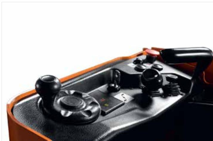
Fácil conducción con un pequeño volante electrónico
