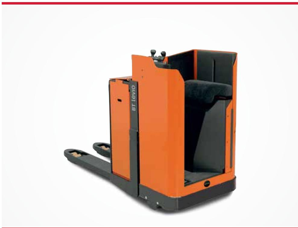
Cabina completamente cerrada y posición de conducción transversal para trabajar en áreas congestionadas
