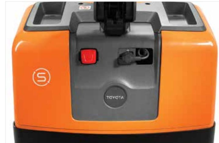
El panel de control incluye un cable de alimentación extraíble para el cargador de batería integrado
