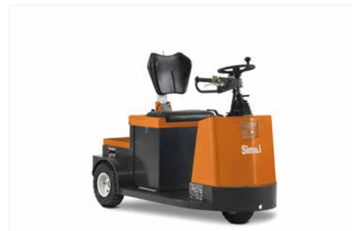
Tractor de arrastre 2 en 1 con conductor sentado y de pie con un escalón de baja altura para una fácil subida y bajada para la preparación de pedidos o envíos urgentes.
