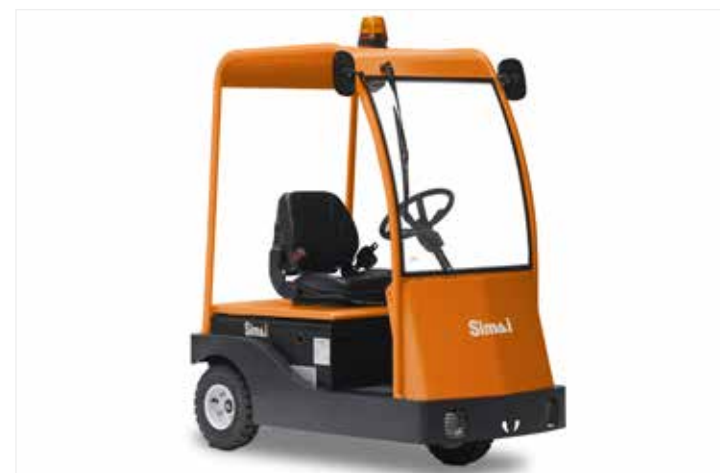
Opciones de techo para proteger al conductor en condiciones climatológicas adversas.
