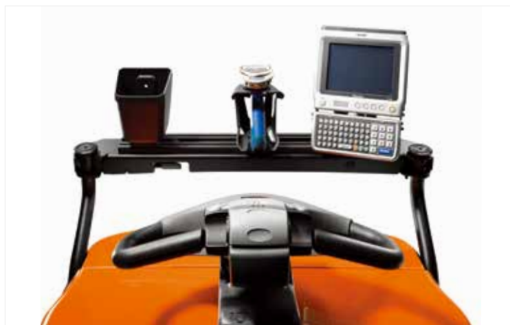
La E-bar incorpora una fuente de alimentación y permite acoplar con facilidad equipos fundamentales como terminales y escáneres de código de barras.
