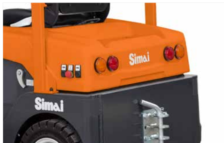
Botones de desplazamiento lento que permiten el retroceso para la conexión con el portacargas.
