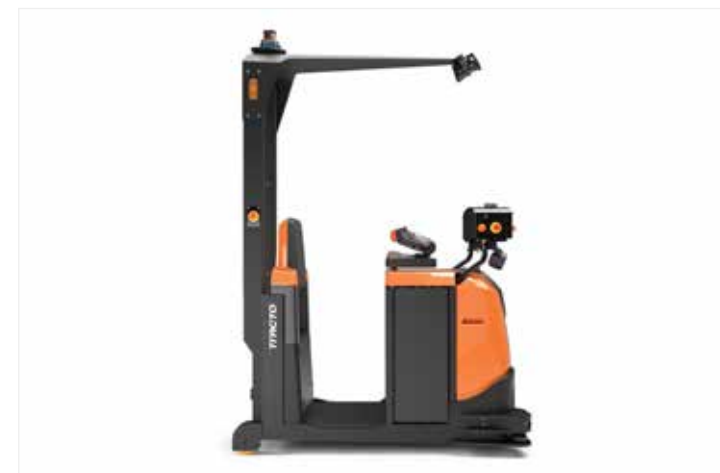
Las carretillas de arrastre automatizadas (Autopilot TAE500) asumen tareas repetitivas entre líneas de producción y zonas de almacenamiento o sistemas de cintas transportadoras.
