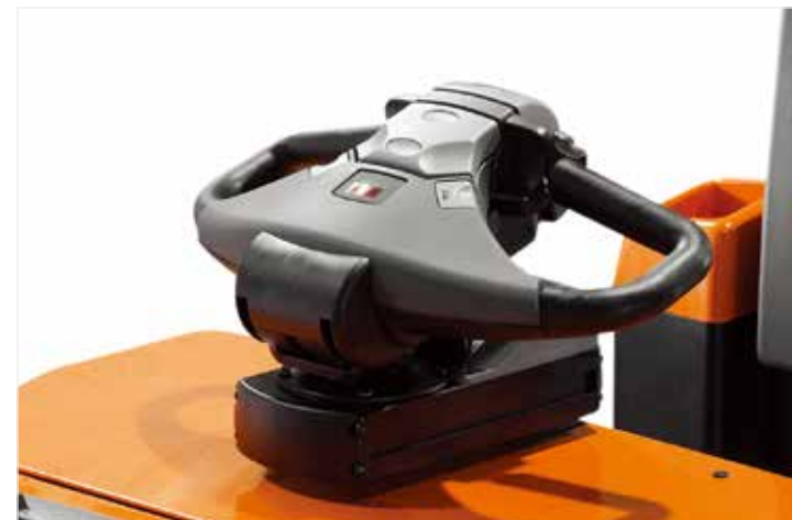
El sistema de control E-man puede trasladarse a cualquiera de los lados de la carretilla para facilitar el uso en modo conductor acompañante.
