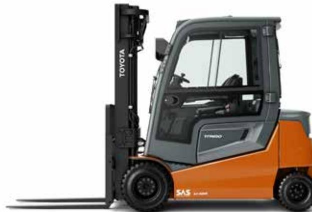
La cabina totalmente flotante aísla al conductor de las vibraciones y el ruido para un mayor confort y productividad.
