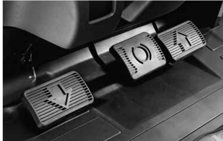
Diferentes diseños de pedales que se adaptan a las preferencias del conductor (se muestra la opción de diseño de doble pedal).
