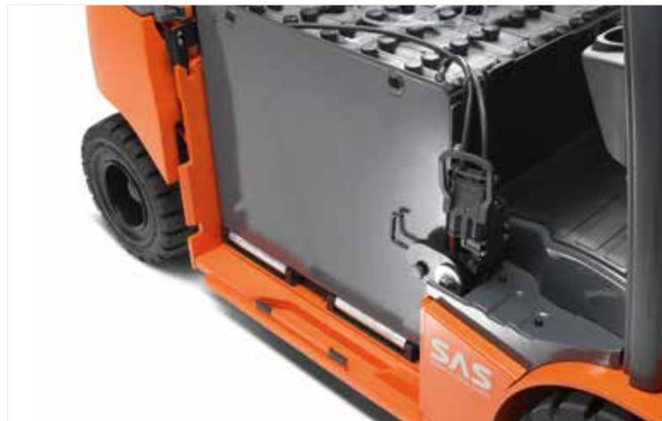
Batería montada sobre una plataforma con ruedas opcional, para facilitar la extracción. Como alternativa, las cavidades para horquillas permiten emplear otra carretilla para extraer la batería.
