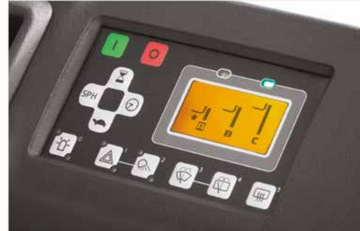
Los preajustes en altura de elevación ahorran tiempo y esfuerzo para el conductor.
