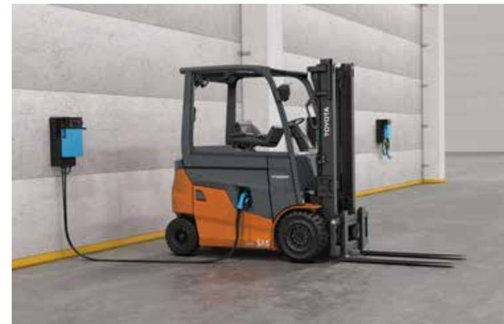
Los paquetes de energía basados en las soluciones de baterías de litio de bajo consumo energético permiten realizar operativas de uso intensivo, ahorrando en costes y reduciendo las emisiones de CO2.
