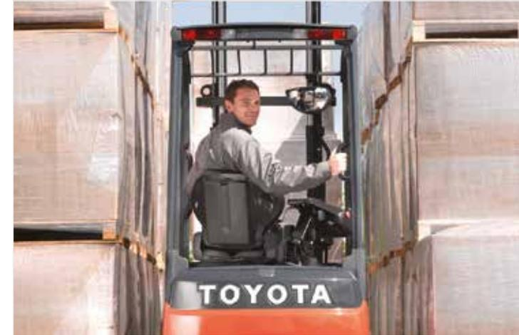
El asidero de apoyo trasero mejora el confort en marcha atrás y la productividad al reducir la tensión de la espalda del operario. El asiento giratorio opcional facilita conducir en marcha atrás, además de la entrada y la salida de la carretilla.
