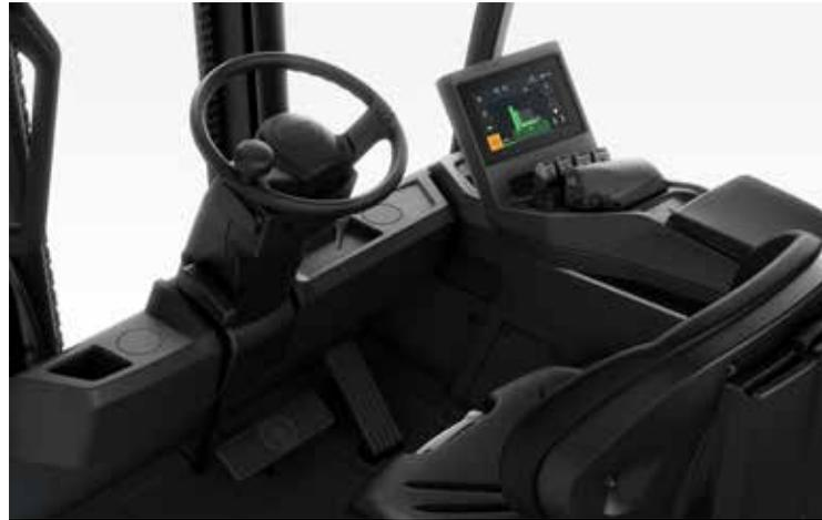
Compartimento del operario con diseño ergonómico, que incorpora un nuevo reposabrazos y un soporte para la palma de la mano con el fin de lograr el máximo confort del conductor.
