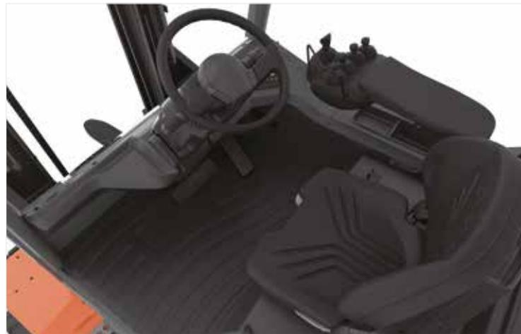
El espacioso compartimiento del conductor totalmente flotante, con niveles mínimos de vibración y ruido, ofrece al operario un espacio de trabajo cómodo.
