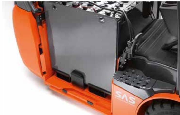
Extracción lateral de la batería con cavidades para horquillas (imagen) o plataforma con ruedas incorporada.
