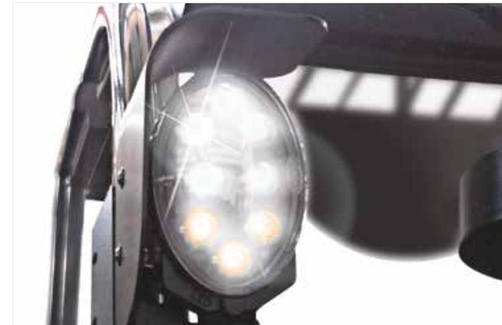
Las potentes luces de trabajo LED eficientes energéticamente aumentan la visibilidad y permiten continuar trabajando en zonas oscuras o sin iluminación.
