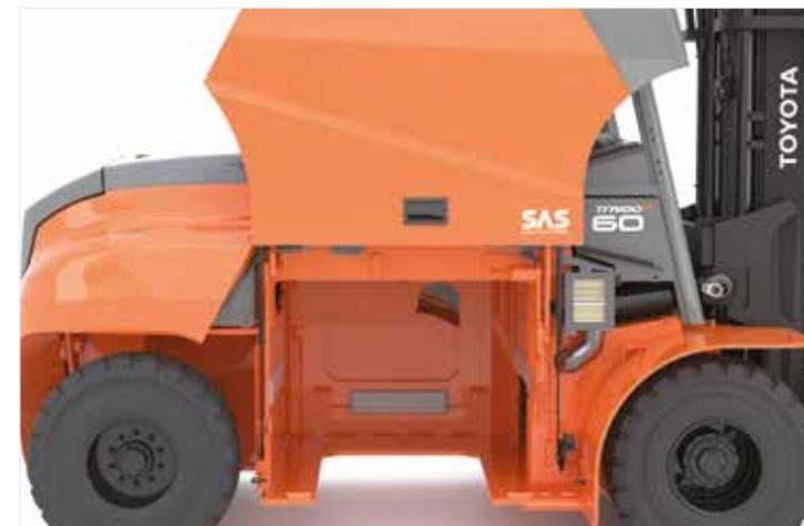
Diseño de chasis abierto con panel lateral para facilitar el cambio lateral de la batería.
